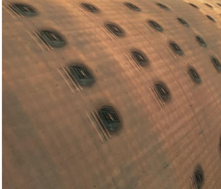
valcu, na papier. V tejto fáze sa papier vtlačí do zárezov naplnených farbou, vďaka čomu na ňom vznikne reliéfny vzor. Týmto spôsobom vzniká na bankovkách reliéfna tlač. Na dosiahnutie požadovaného reliéfnego vzhľadu je pri tlači potrebné vyvinúť tlak o sile približne 30 ton.
