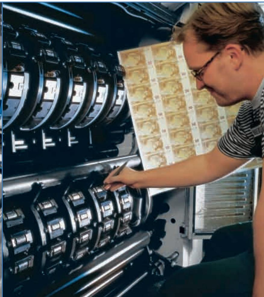
Stroj na siet'otlač, v ktorom sa na bankovky 50 € aplikuje opticky premenlivá farba.
