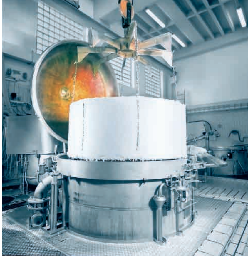
Fibre di cotone dopo il processo di sbiancamento.
