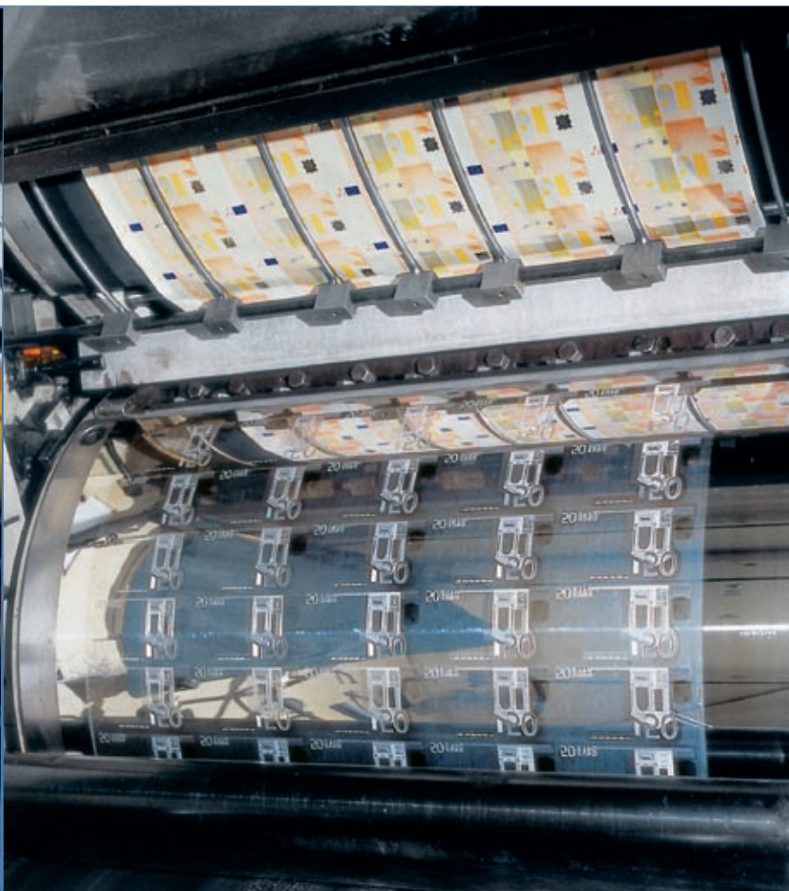
Cilindro portalastra per la stampa delle banconote da €50 in una macchina da stampa calcografica.
