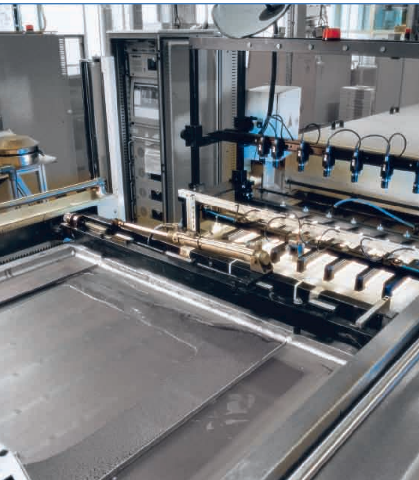
Šilkografijos spausdinimo mašina spalvą keičiantiems dažams įterpti į 50 € banknotus.
