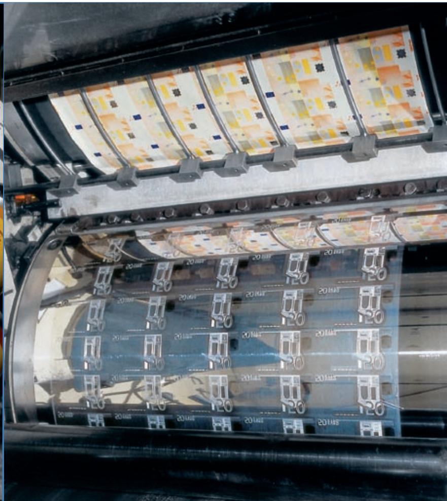
Az 50 eurós bankjegy nyomtatásánál használt lemezhenger mélynyomtató gépben
