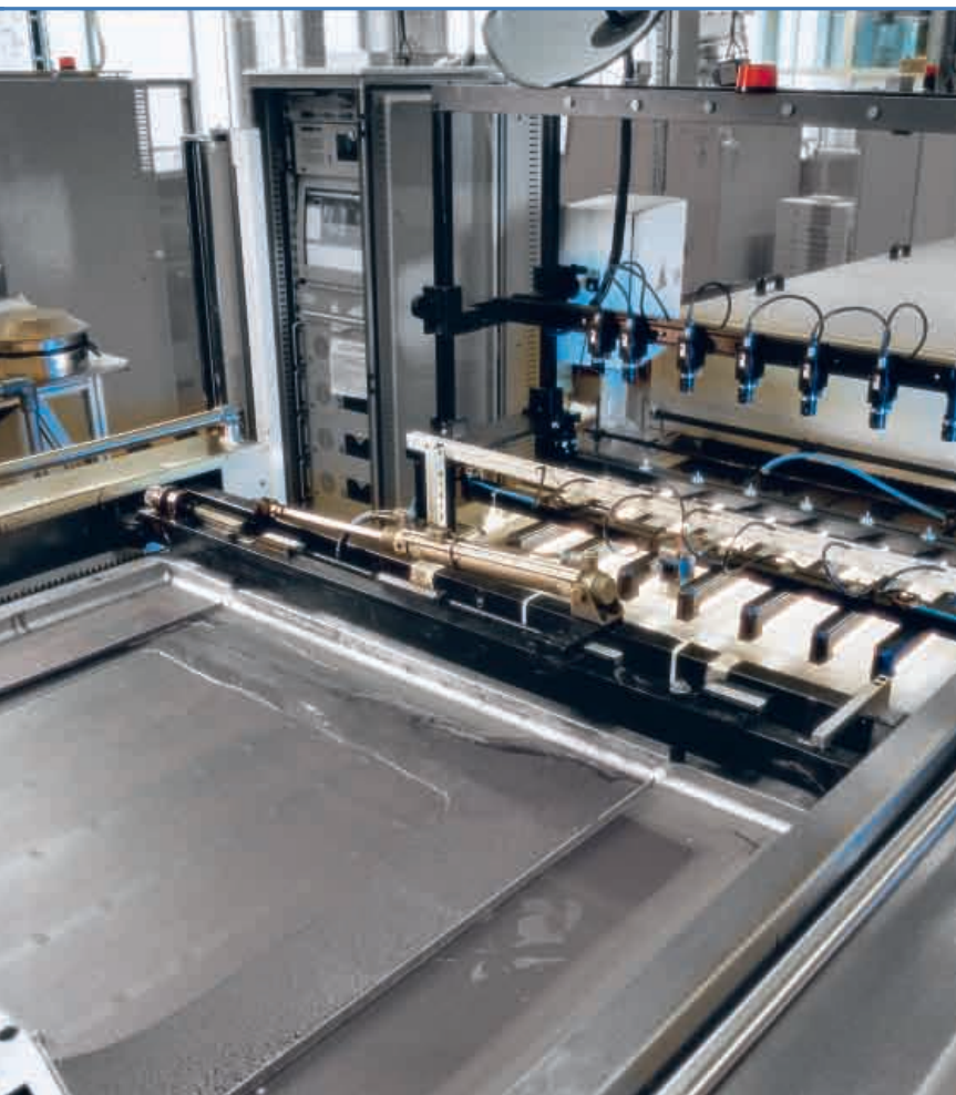
Siiditrukimasin, mille abil kantakse 50-eurostele pangatähtedele muutuva tooniga trükivärv.
