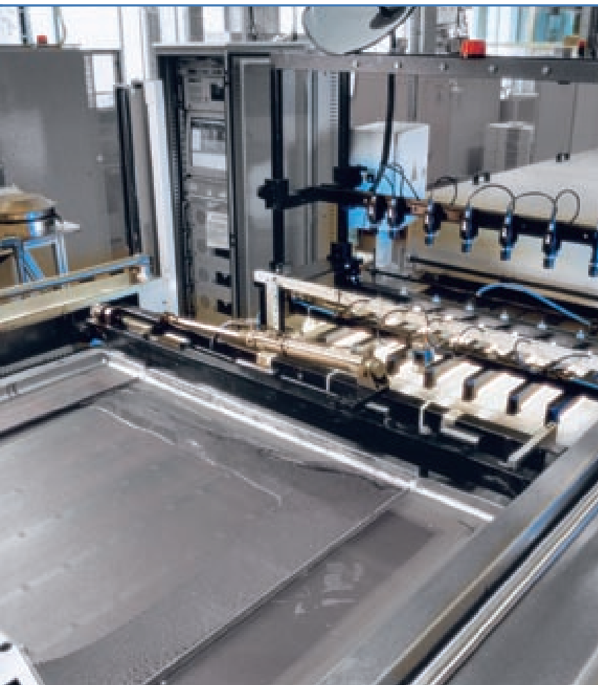
Eine Siebdruckmaschine für das Aufbringen der optisch variablen Farbe auf 50-€-Banknoten.
